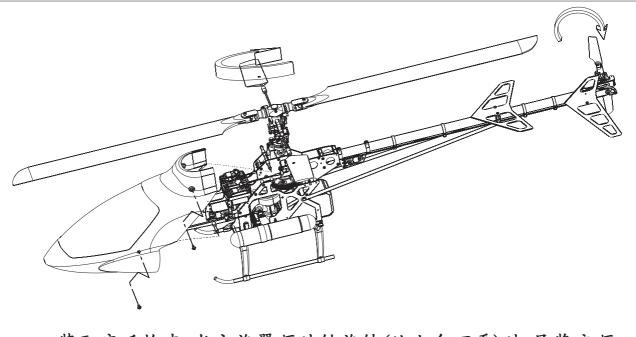
装配完后检查,当主旋翼顺时针旋转(从上向下看)时,尾桨应顺时针旋转(机头在左,尾管在右时的视角)。如图示。否则,则有装配错误。
